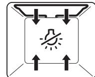
Il riscaldamento avviene mediante l'elemento riscaldante superiore e inferiore.
