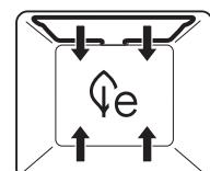
Quest'applicazione consente un notevole risparmio di energia. Il riscaldamento avviene mediante l'elemento riscaldante superiore e inferiore. L'umidità propria generata dagli alimenti viene mantenuta all'interno della camera di cottura. L'alimento si secca meno.
