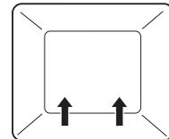
Il riscaldamento avviene mediante l'elemento riscaldante inferiore.
