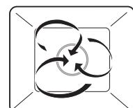
L'aria della camera di cottura viene riscaldata dall'apposito elemento dietro la parete posteriore e circola in modo uniforme. Grazie all'apertura temporizzata della porta, l'umidità prodotta dall'alimento viene espulsa in buona parte a intervalli regolari. L'alimento si secca lentamente.
