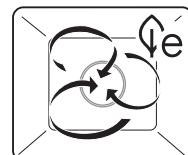
Quest'applicazione consente un notevole risparmio di energia. L'aria della camera di cottura viene riscaldata dall'apposito elemento dietro la parete posteriore e circola in modo uniforme. L'umidità propria generata dagli alimenti viene mantenuta all'interno della camera di cottura. L'alimento si secca meno.
