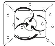
L'aria della camera di cottura viene riscaldata dall'apposito elemento dietro la parete posteriore e circola in modo uniforme. L'umidità propria generata dagli alimenti viene espulsa in misura minima dalla camera di cottura. L'umidità dell'alimento viene preservata.
