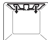
Il riscaldamento avviene mediante l'elemento riscaldante del grill.
