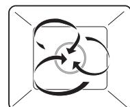
L'aria della camera di cottura viene riscaldata dall'apposito elemento dietro la parete posteriore e circola in modo uniforme.
