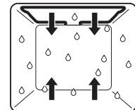
Il riscaldamento avviene mediante l'elemento riscaldante superiore e inferiore. L'umidità propria generata dagli alimenti viene espulsa in misura minima dalla camera di cottura. L'umidità dell'alimento viene preservata.
